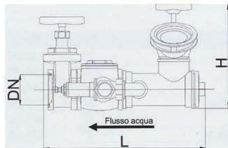
In ottone EN 1982, attacco UNI 70 a norma UNI 808; Connessione idrica filettata femmina GAS ISO 228, valvola di sicurezza tarata a 12 bar
