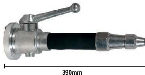
Lancia Antincendio a getto multiplo. Interamente costruita in lega di alluminio leggera con guarnizioni in gomma. Funziona mediante valvola a sfera e tramite un dispositivo produce un largo getto di acqua frazionata. La leva di comando permette il passaggio da chiuso a getto pieno o frazionato. In posizione di getto pieno è garantito un passaggio d'acqua omogeneo.
