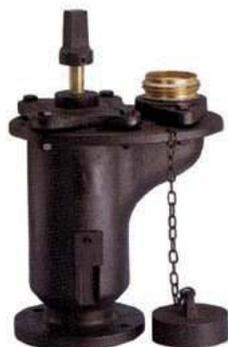
In ghisa EN-GJL-250 secondo UNI EN 1503-3, con scarico automatico antigelo; sbocco in ottone EN 1982 e tappo
