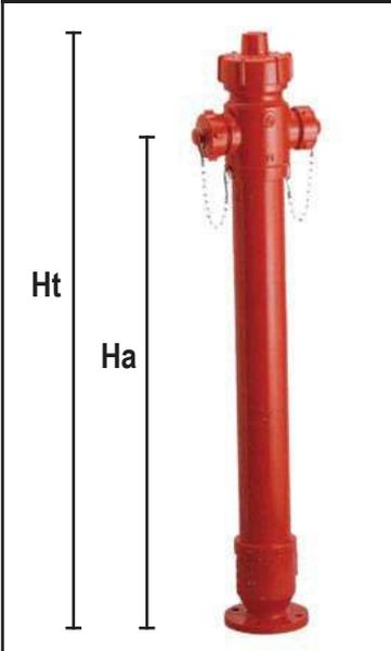
Dotato di scarico automatico antigelo; sbocchi filettati maschio UNI 810 in ottone EN 1982 e con tappi in ottone EN 1982. Attacco flangiato forato PN 16. Verniciatura in rosso RAL 3000
