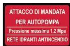
Gli attacchi di mandata per autopompa devono essere installati in modo da non provocare strozzature nelle tubazioni flessibili di adduzione, essere protetti da urti o altri danni meccanici e dal gelo e devono essere ancorati in modo stabile al suolo o al fabbricato.
