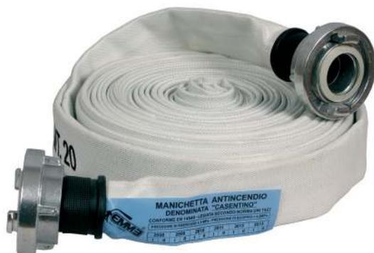
Manichetta realizzata conforme alla EN 14540 (DN 45) e alla UNI 9487 (DN 70). Fornita completa di raccordi STORZ in lega leggera con legatura a norma UNI 7422 e manicotti copri legatura.
