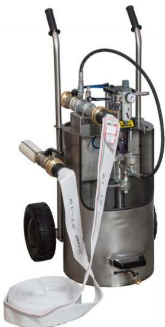
Unità pneumatica multifunzione per il collaudo e l'asciugatura di tubazioni antincendio ed estintori a max 60 bar. Interamente realizzato in acciaio INOX e dotato di due ruote che ne facilitano il trasporto. Alimentazione ad aria 4 bar max, serbatoio scorta acqua lt 25. Dotato di serie di raccordi UNI45 ,spugna per asciugatura, una chiave idrante tipo A, una gabbietta recupero spugna.
