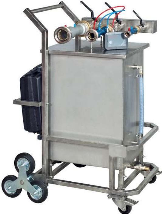
Carrello per prove di pressione e portata per attacchi manichette al piano. Struttura in acciaio inox. Ruote per scalini e ruote direzionali con freno. Serbatoio da lt. 120 Circa. Valvola di scarico acqua. Controllo livello acqua. Collettore per uni 70 – uni 45 – uni 25. Valvole di selezione ingresso acqua flussometri . Sistema con app da cellulare di pressione e portata.
