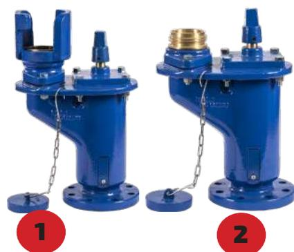
Idrante sottosuolo in ghisa conforme EN 14339 per pressioni d'esercizio fino a 16 bar. Flange dimensionate EN 1092-2 PN 16. Dotato di scarico antigelo che consente lo scarico completo a chiusura totale della valvola. Altezza della flangia al cappello di manovra mm 450. Apertura e chiusura tramite utilizzo della chiave di manovra al cappello quadro
