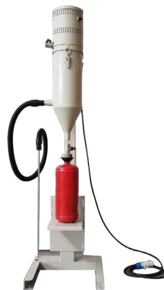
**APPARECCHIATURA PER IL RIEMPIMENTO DI ESTINTORI PORTATILI E CARRELLATI A POLVERE**
