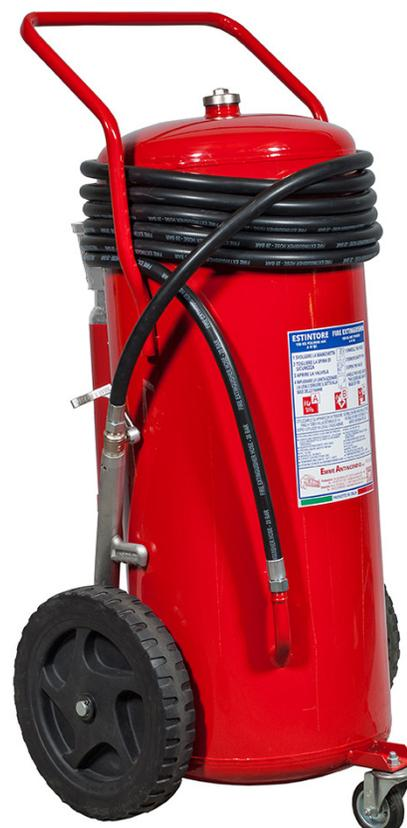
Estintore a polvere polivalente ABC pressurizzato al momento dell'uso con bombola esterna di Co2. Involucro realizzato in acciaio al carbonio con struttura saldata direttamente all'involucro. Realizzato con manichetta in gomma, dotato di lancia in alluminio ad alta resistenza per applicazioni in spazi all'aperto.
