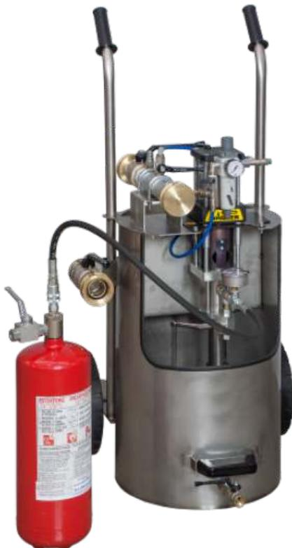
Unità pneumatica multifunzione per il collaudo e l'asciugatura di tubazioni antincendio ed estintori a max 60 bar. Interamente realizzato in acciaio INOX e dotato di due ruote che ne facilitano il trasporto. Alimentazione ad aria 4 bar max, serbatoio scorta acqua lt 25. Dotato di serie di spugna UNI45 per asciugatura, una chiave idrante tipo A, una gabbietta recupero spugna. Peso 35 kg
