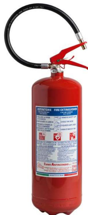
Estintore a polvere polivalente ABC dotato di manichetta di erogazione in gomma con ugello in ottone. Realizzato in acciaio al carbonio a profondo stampaggio con valvola dotata di disco di sicurezza.
