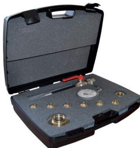
Il kit misuratore di pressione e portata è da utilizzarsi per la misurazione della pressione dinamica nelle reti idranti. La determinazione della portata d'acqua in funzione della pressione residua per idranti UNI 45, UNI 70 e naspi DN 25; misurazione da effettuarsi per la verifica degli impianti antincendio conformi alla norma UNI 10779.
