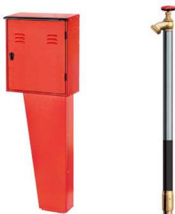
Il sistema nasce per l'installazione di idranti DN45 ad umido per installazione esterne dove è possibile riscontrare danni dovuti al gelo. Il rubinetto e il tampone di chiusura, posizionato nella parte interrata dotato di scarico antigelo, così distanziati creano una colonna a secco evitando danni dovuti al gelo. Disponibile il sistema completo di piantana e cassetta corredo idrante per nuove installazioni o solo il rubinetto a secco per sostituzioni o adeguamento dei sistemi esistenti.
