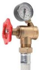
ATTENZIONE: la norma UNI 10779 sulle reti idranti prevede che in prossimità dell'ultimo naspo di ogni diramazione aperta si debba installare una valvola con manometro per misurare la pressione residua
