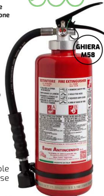
Estintore a base d'acqua con agente estinguente premiscelato realizzato con involucro in acciaio Inox. Costruito con valvola in alluminio con ghiera girevole esterna per permettere il corretto allineamento dell'etichetta di marcatura in fase di manutenzione. Idoneo per utilizzi per fuochi derivanti da olii utilizzati in cucina.
