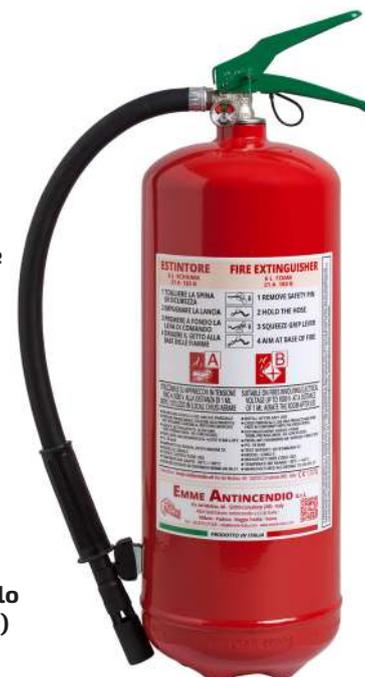
Estintore a base d'acqua con agente estinguente premiscelato in grado di resistere alle basse temperature fino a -30°C prima di trovare il punto di congelamento. L'estintore è realizzato con involucro in acciaio con trattamento interno di plastificazione e dotato di ugello di erogazione ad alte prestazioni. Ideale per installazione a bordo di automezzi o veicoli adibiti al trasporto di persone.
