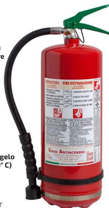
Estintore a base d'acqua con agente estinguente premiscelato in grado di resistere alle basse temperature fino a -30°C prima di trovare il punto di congelamento. L'estintore è realizzato con involucro in acciaio inox. Ideale per installazione a bordo di automezzi o veicoli adibiti al trasporto di persone.
