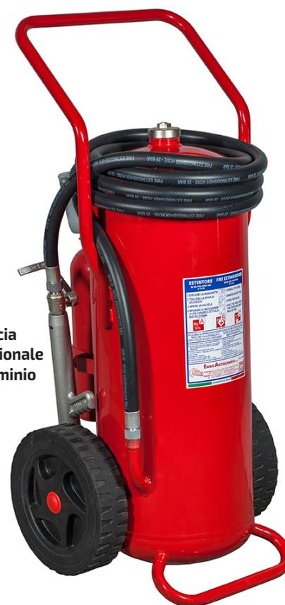
Estintore a polvere polivalente ABC. Pressurizzato al momento dell'uso con bombola esterna. Serbatoio realizzato in acciaio al carbonio saldato direttamente al telaio. Manichetta in gomma e lancia di erogazione in alluminio ad alta resistenza per applicazioni all'aperto.
